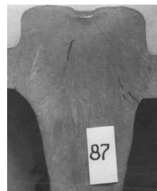
Рис. 2. График определения критической скорости сварки (а) и фотографии макрошлифов образцов (б).
