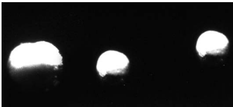
Рис. 4. Частицы порошка ПГ-19М-01 после прохождения пламени (ацетилен+O 2 )
