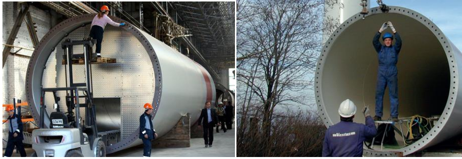
Рис.1 – Фланець секції вежі ВЕУ
