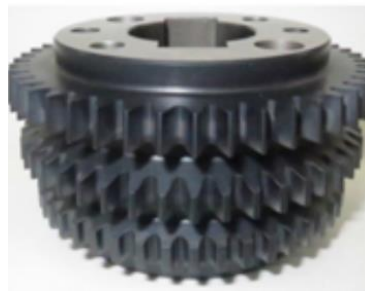
Рис.2. Конструкція комбінованого скайвінг-різка
