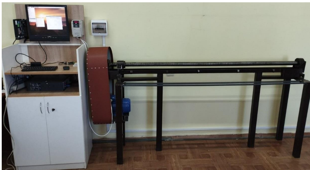
Рис. 1 Фотографія навчального стенду управління асинхронним двигуном
