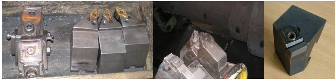
Рис. 1. Основні типи різальних інструментів, які використовуються на важких токарних верстатах
