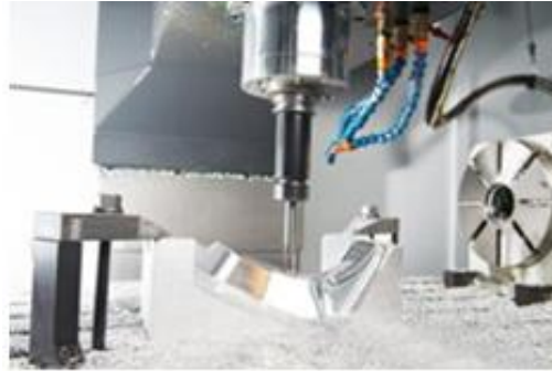
Рис. 1. Високошвидкісна фрезерна обробка металу на верстаті з ЧПУ
