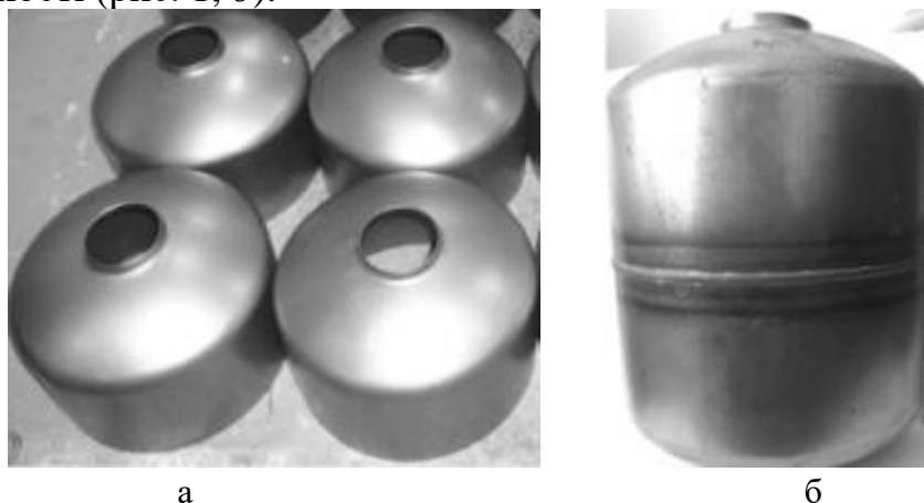
Рис. 1. Напівфабрикати після відбортування отворів у дні (а) та готова ємність для нагрівання води після зварювання напівфабрикатів (б)
