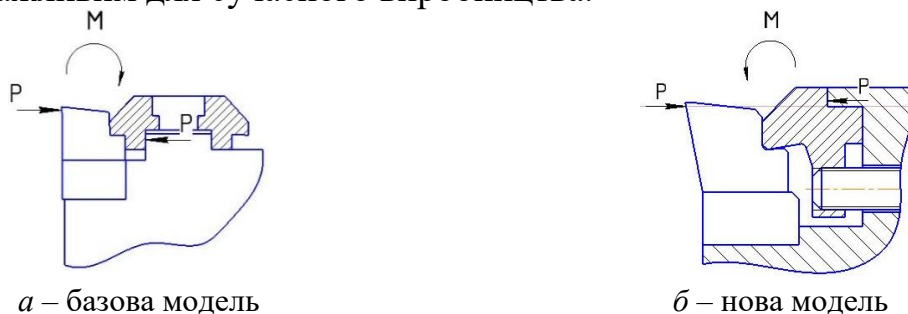
Рис. 1. Вузол кріплення різальної пластини базової і нової конструкції.
