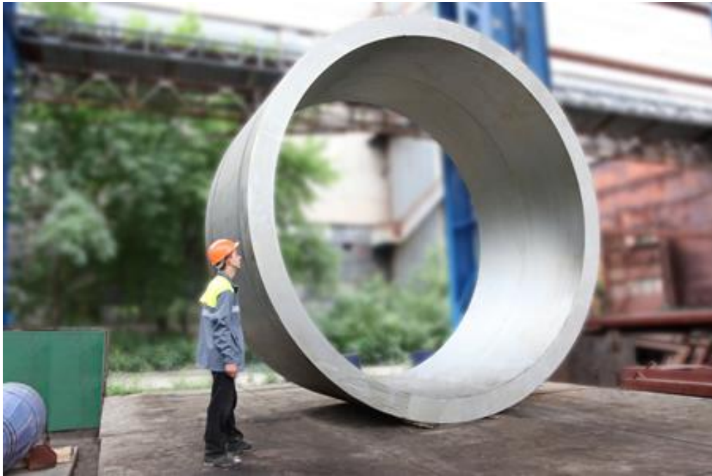
Рисунок 1.1 – Обичайка (вага 62300 кг)
