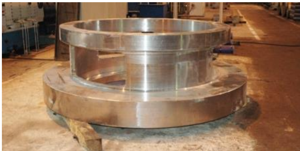
Рисунок 1.15 – Проставка (вага 12800 кг)
