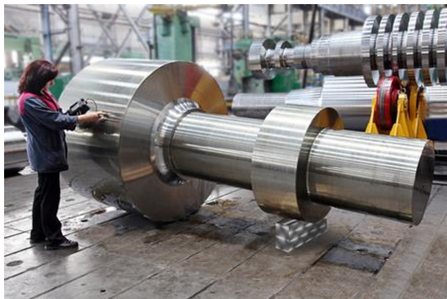
Рисунок 1.3 – Хвостовик (вага 12200 кг)
