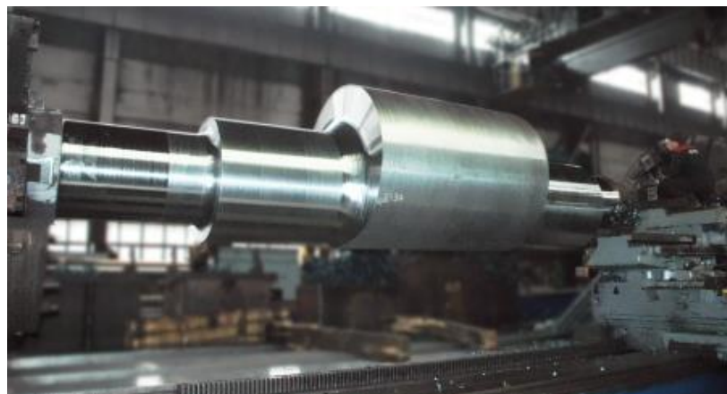
Рисунок 1.10 – Вал ексцентрик (вага 81000 кг)
