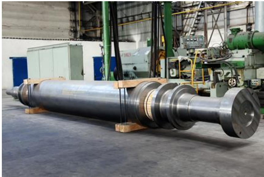
Рисунок 1.4 – Ротор генератора (вага 43125 кг)
