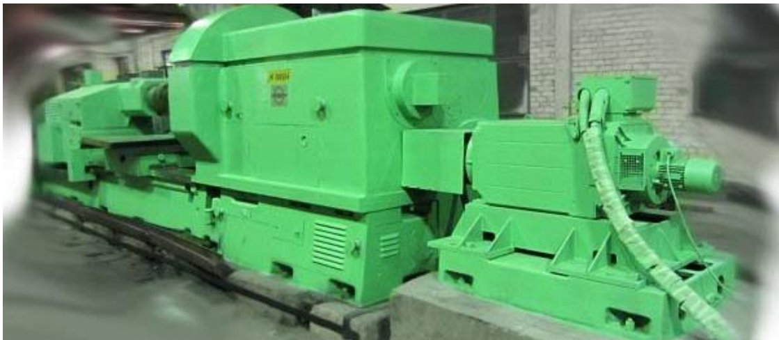
Рисунок 1.24 – Загальний вид верстата моделі 1К660Ф3
