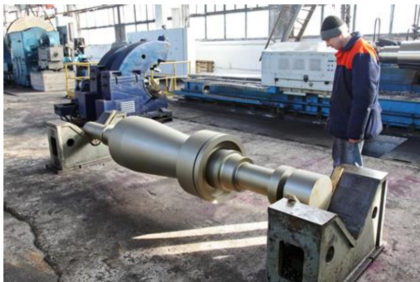
Рисунок 1.5 – Ротор турбіни (вага 3225 кг)
