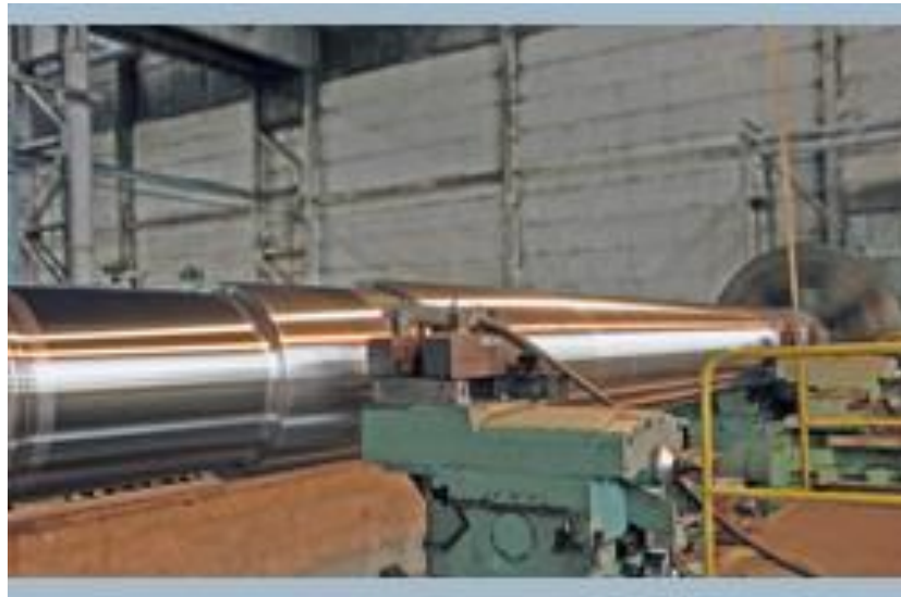
Рисунок 1.9 – Гребний вал (вага 61000 кг)
