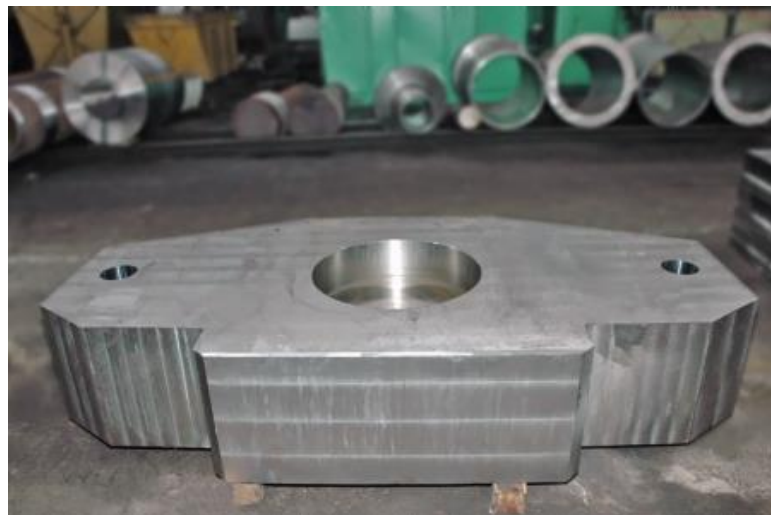
Рисунок 1.19 – Рухома траверса (вага 11960 кг)
