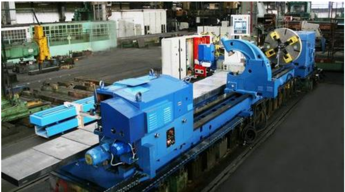
Рисунок 1.25 – Загальний вид верстата моделі 1К665Ф3
