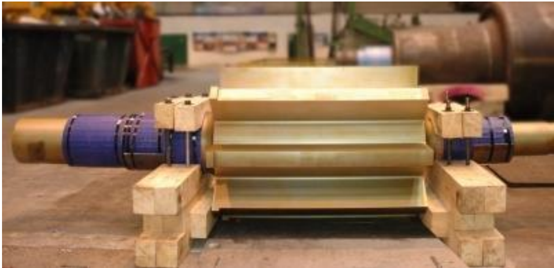
Рисунок 1.6 – Вал ротора (вага 5800 кг)
