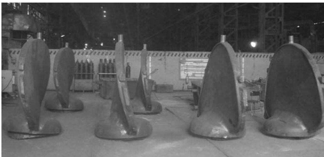
Рис.1. Отливки «Лопастей винта» для ледокола.
