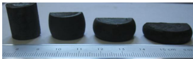
Рисунок 1 – Общий вид цилиндрических образцов после осадки
