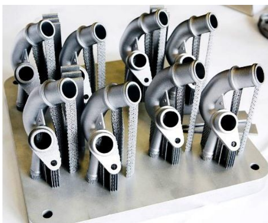
Рис. 1. Металеві 3D-друковані роз'єми для двигуна Audi W12 [1]
