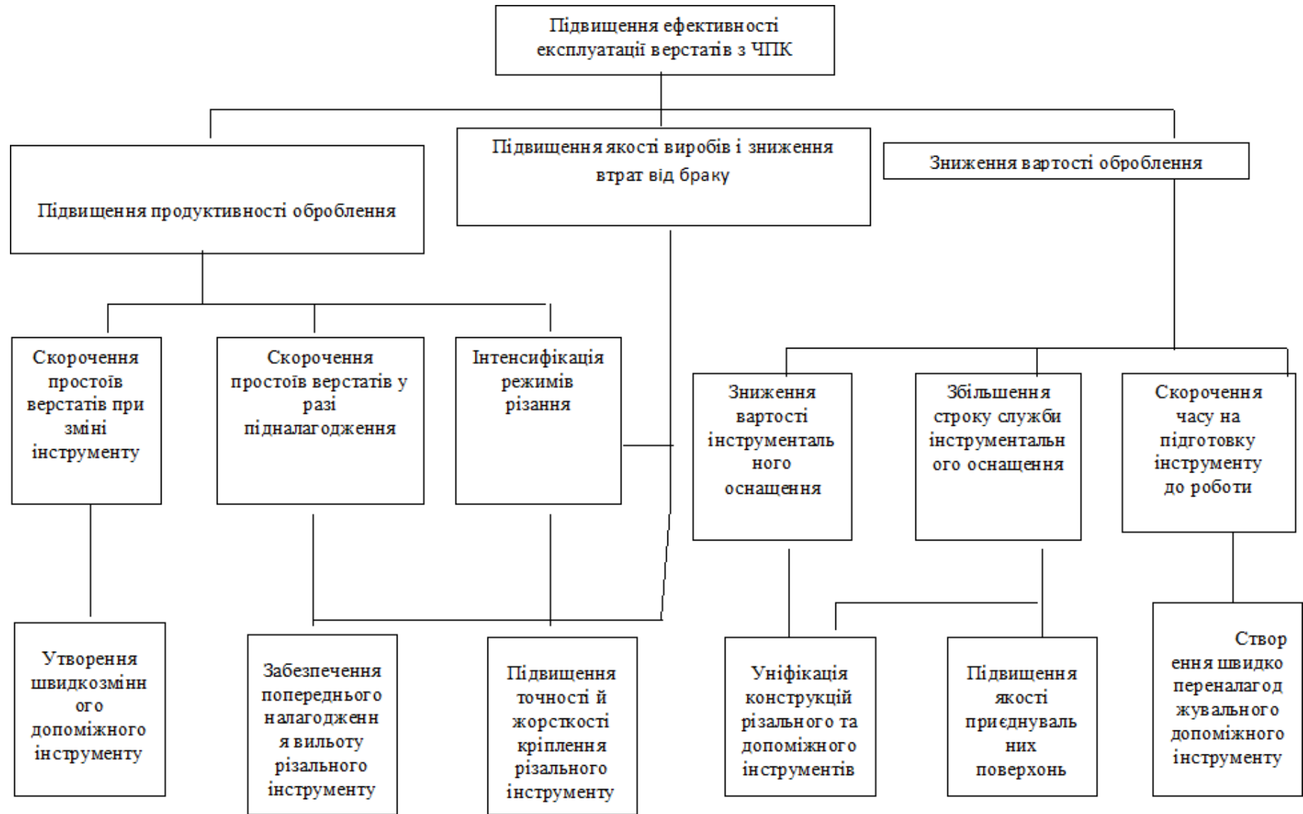
Рисунок 3.3 – Критерії вибору оптимальних конструкцій допоміжного інструменту для верстатів з ЧПК
