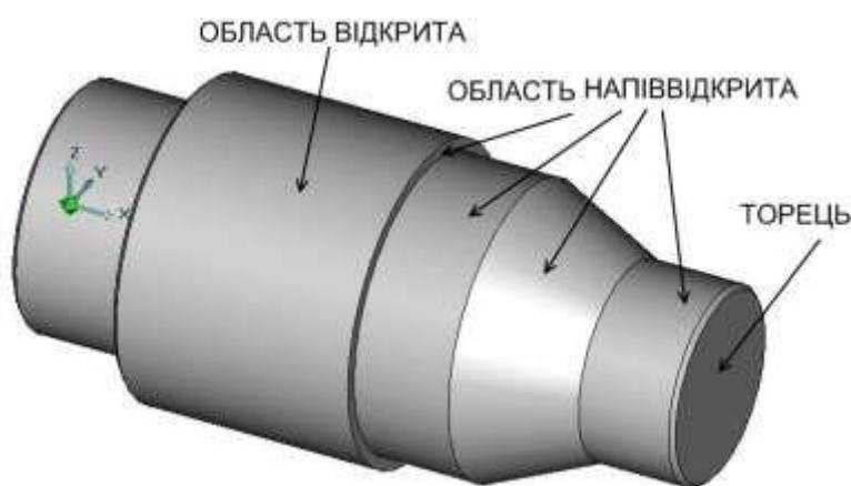
Рисунок 2.7 – Приклади конструктивних елементів деталі типу тіл обертання
