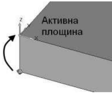
Рисунок 2.49 – Зміщення початку системи координат
