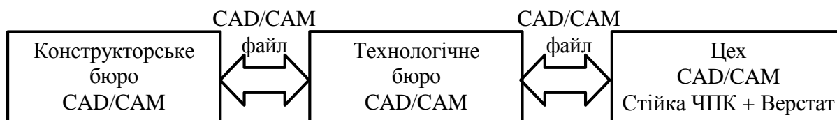
Рисунок 2.2 – Економічна схема програмування верстата з ЧПК
