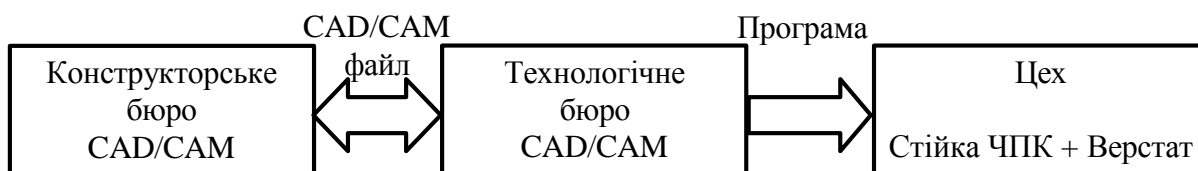
Рисунок 2.1 – Традиційна схема програмування верстата з ЧПК
