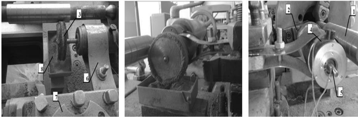
1 – заготовка; 2 – патрон ГОСТ 2675-80; 3 – барабан з магнітом Ø75мм; 4 – двигун постійного струму (ДПС); 5 – струмознімач; 6 – тримач; 7 – різцетримач; 8 – тара з абразивом та Al порошком Рисунок 5.1 – Експериментальна установка для проведення електромагнітно-абразивної обробки
