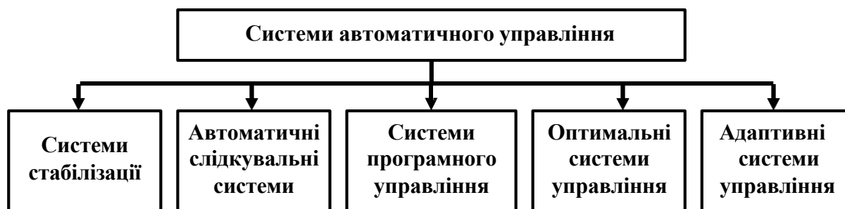
Рисунок 8.1 – Класифікація систем автоматичного управління
