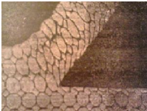
Рисунок 6.1 – Пластична деформація поверхневого шару під час різання
