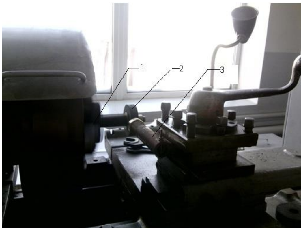
Рисунок 18.3 – Установка для зношення шліфувального круга
