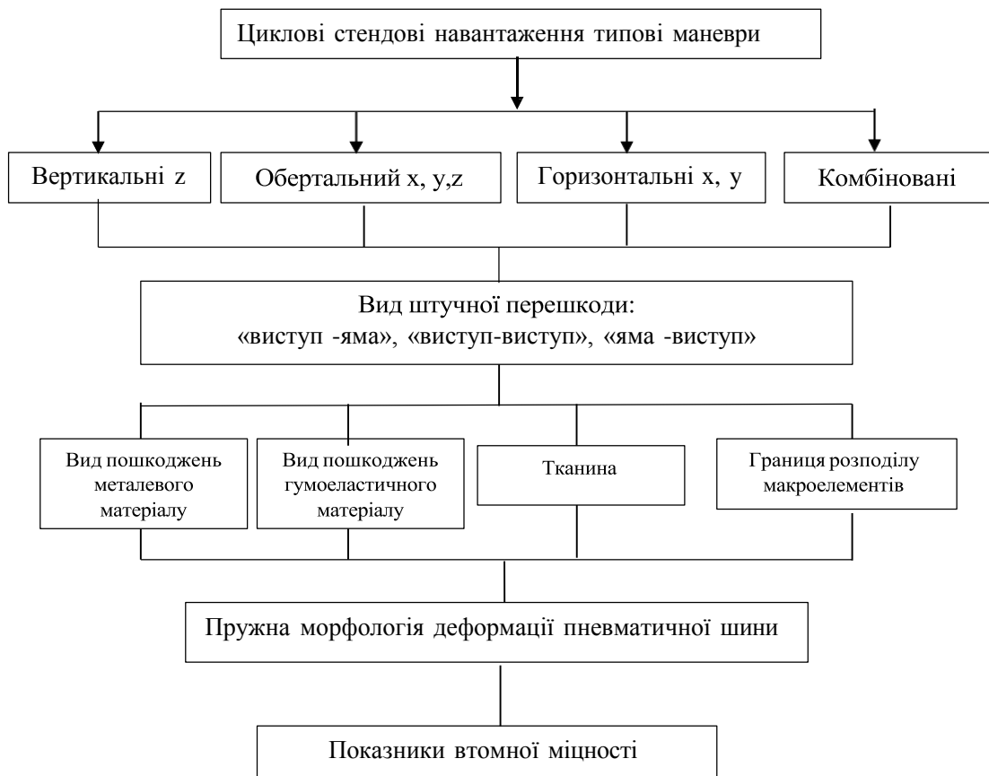
Рис.3 Блок схема послідовності визначення змін втомної міцності при стендових випробуваннях радіальної пневматичної шини
