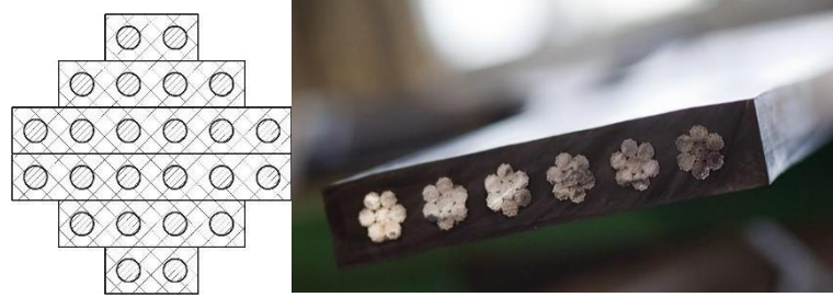
Рис. 1 – Багатошарова ванта із композитних канатів
