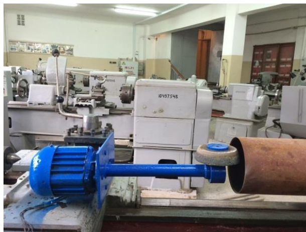
Рис. 1 – Схема обробки шліфуванням отвору у циліндрі
