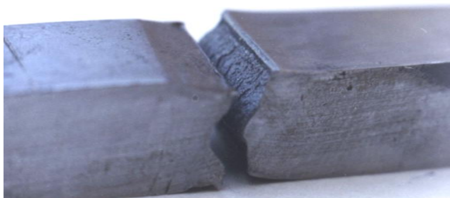
Рисунок 3.34 – Заготовки из стали ВСтЗпс, полученные способом «сдвиг –ломка» с нанесением концентратора напряжений динамической силой
