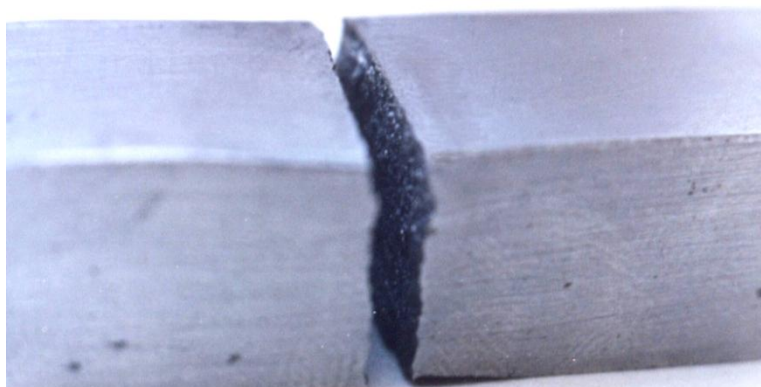
Рисунок 3.32 – Заготовки из стали У8А, полученные способом «сдвиг – ломка» с нанесением концентратора напряжений динамической силой
