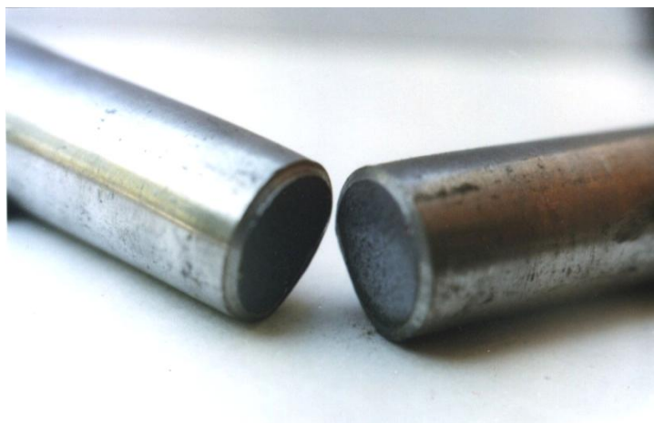
Рисунок 3.22 – Заготовки из стали 50ХФА, полученные способом трёхточечной холодной ломки изгибом при статико-динамическом нагружении
