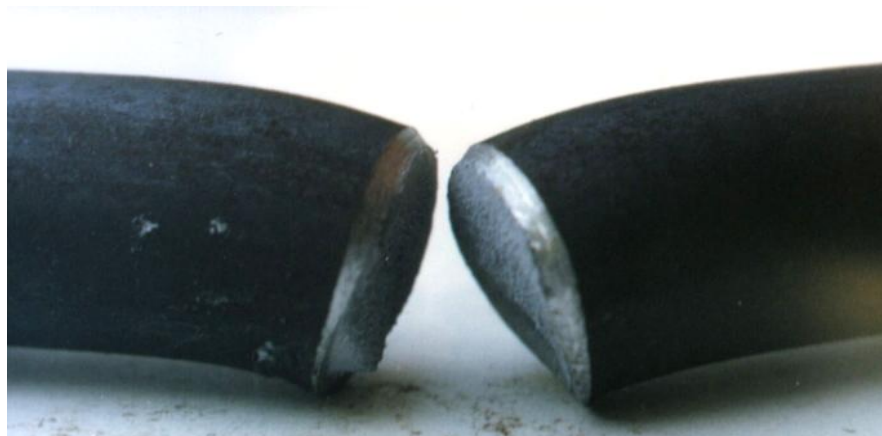
Рисунок 3.25 – Заготовки из стали ВСтЗпс, полученные способом трёхточечной холодной ломки изгибом при статико-динамическом нагружении
