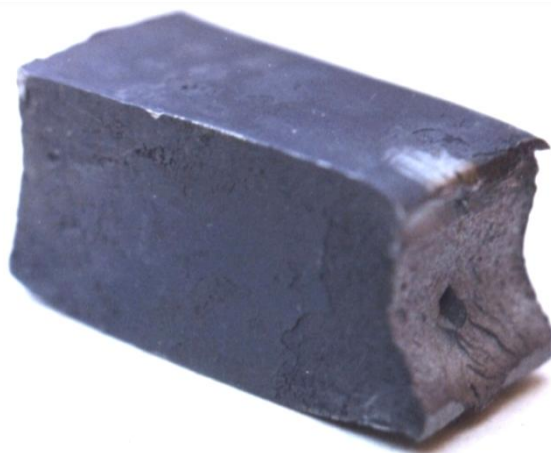
Рисунок 3.35 – Заготовка из стали 20Х, полученная способом «сдвиг – ломка» с нанесением концентратора напряжений динамической силой
