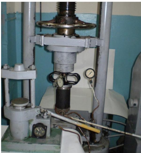
*Рисунок 3.21 – Общий вид экспериментальной установки для исследования влияния величины давления на контактных поверхностях КШМ с ВК на коэффициент трения*
