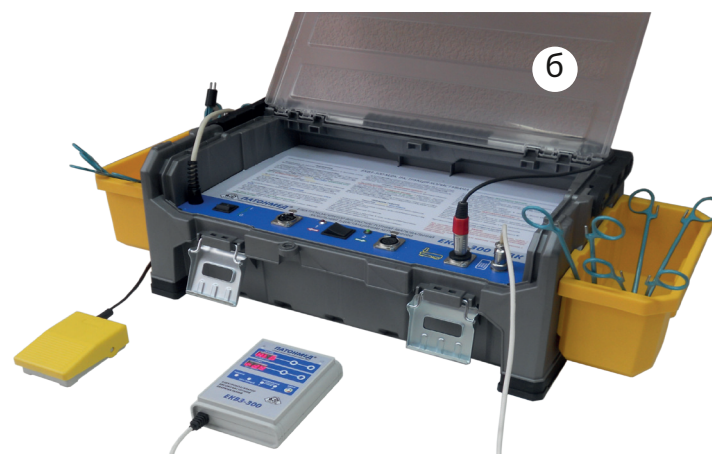
Рис.3. Універсальні мобільні апарати для високочастотного зварювання живих тканин з вбудованим (а) і виносним (б) пультом керування
