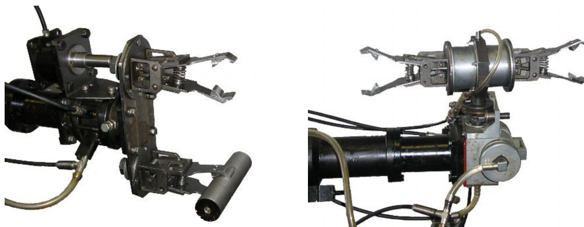
Рис. 4.18. Двозахватні пристрої, розроблені кафедрою технології машинобудування КНТУ
