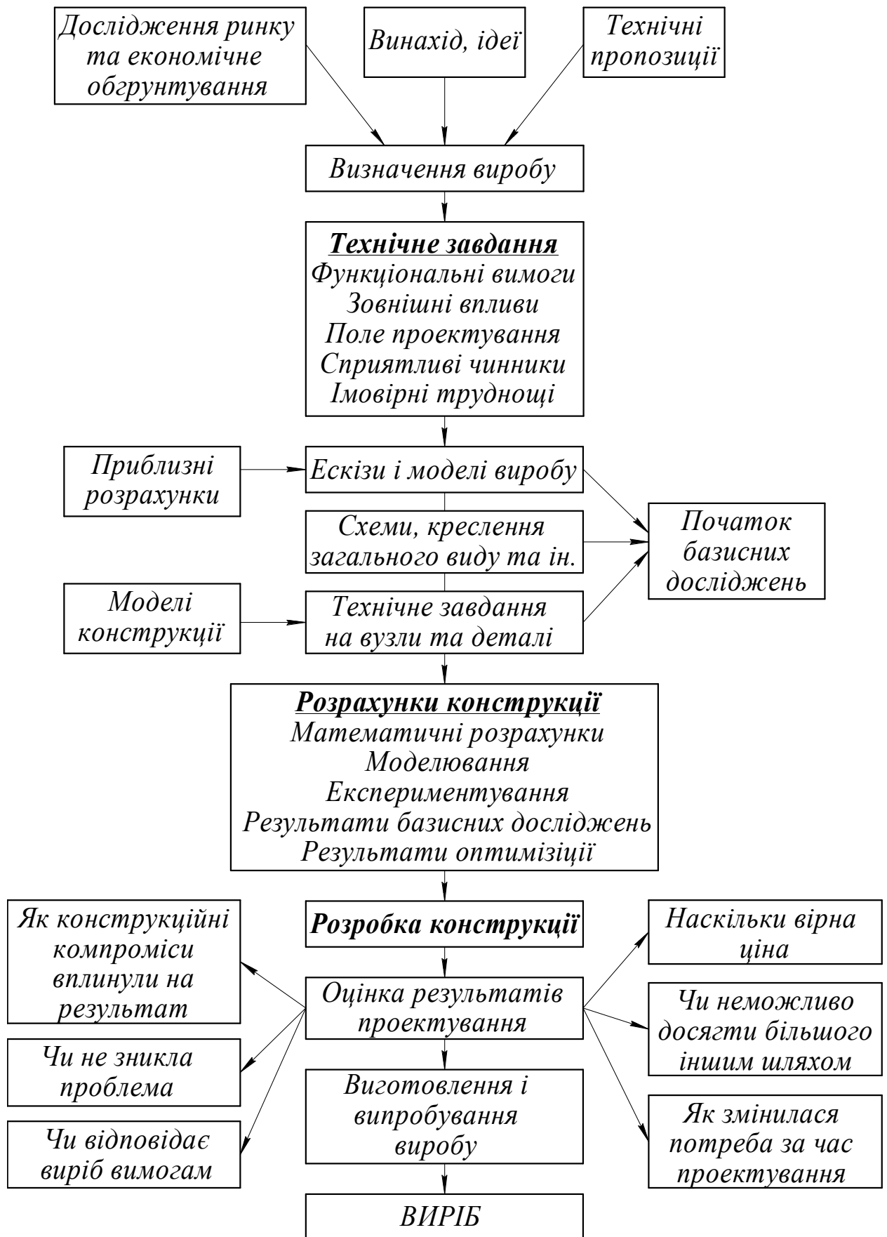
Рис. 1.15. Схема процесу проектування
