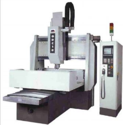
GDC1012 – портальний двошпиндельний свердлильний верстат з ЧПК (Китай)
