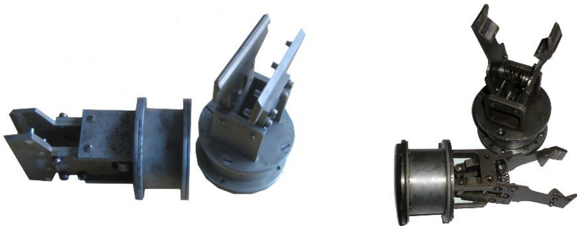
Рис. 4.4. Конструкції захватних пристроїв, що розроблені кафедрою технології машинобудування КНТУ
